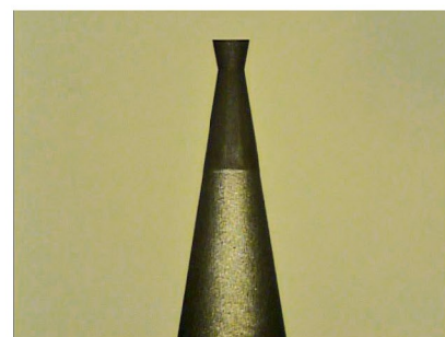
写真2:特殊形状のPCD工具（先端径0.35φ/±10度、写真は100倍に拡大）でマイクロニードルのアンダーカット部を加工（三井刻印提供）
